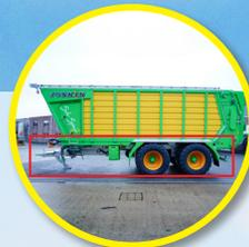
Châssis indépendant, structure et tôles de fond de caisse galvanisés pour plus de longévité
